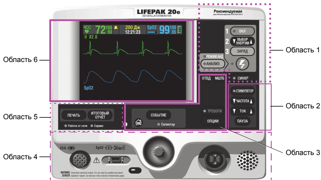
Рис. 2-3 Вид передней панели без дверцы
