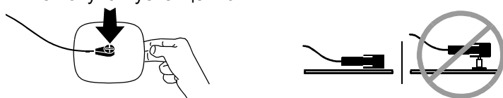
Рис. 5-4 Подсоединение электродов FAST-PATCH к дефибрилляционному кабелю
