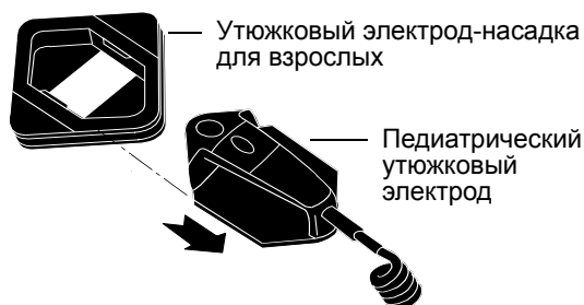
Рис. 5-9 Доступ к педиатрическому утюжковому электроду
