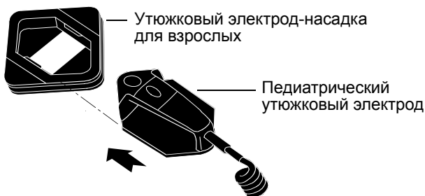
Рис. 5-11 Замена педиатрического утюжкового электрода
