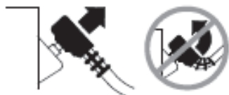
Рис. 5-7 Отсоединение дефибрилляционного кабеля от клеммы тестера
