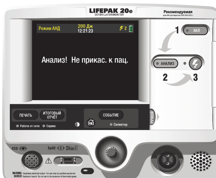
Рис. 2-2 Вид передней панели с дверцей
